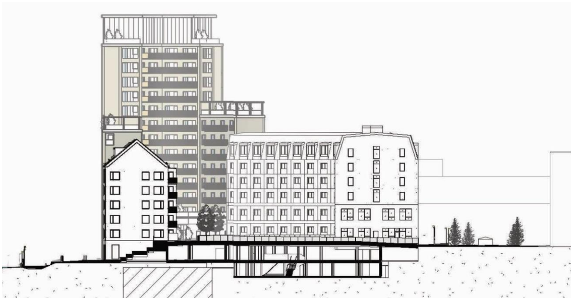
Bild 25. Sektion D-D, tvärsektion med vy österut. (Skrafferingen avser dagvattentunnelns skyddsområde).
